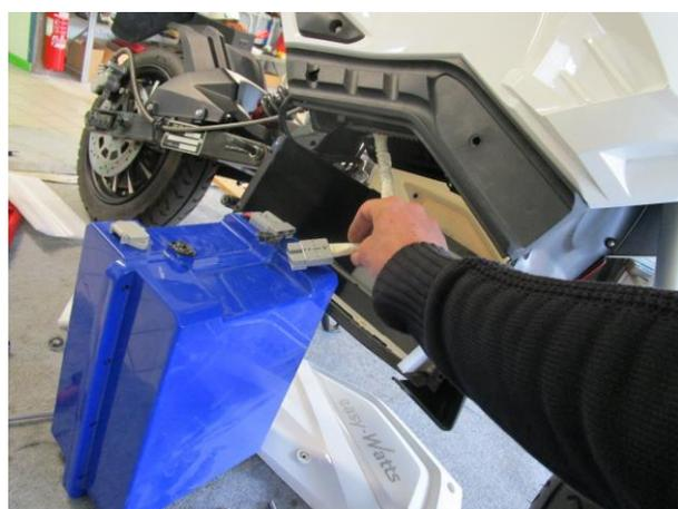
Sortir la batterie et la débrancher
