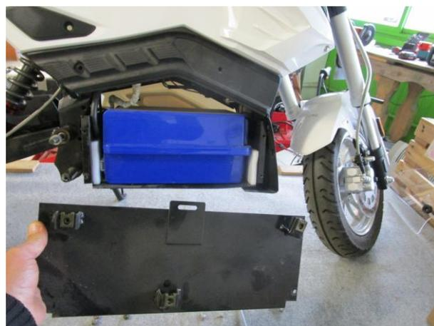
Dévisser les 4 vis et retirer la tôle d'accès batterie
